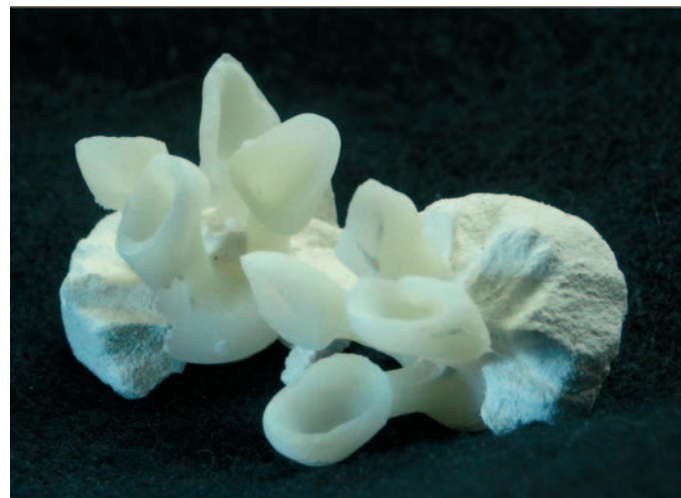
Figure 2. Armature céramique : sorties de coulée du système Empress2 ® .
